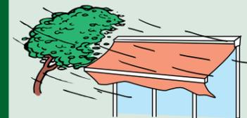
2 手動式の場合、キャンバスにたるみがなくピンとはった状態になるように調整して下さい。
