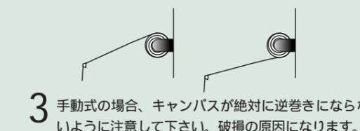
3 手動式の場合、キャンバスが絶対に逆巻きにならないように注意して下さい。破損の原因になります。
