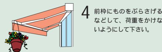
4 前枠にものをぶらさげるなどして、荷重をかけないようにして下さい。
